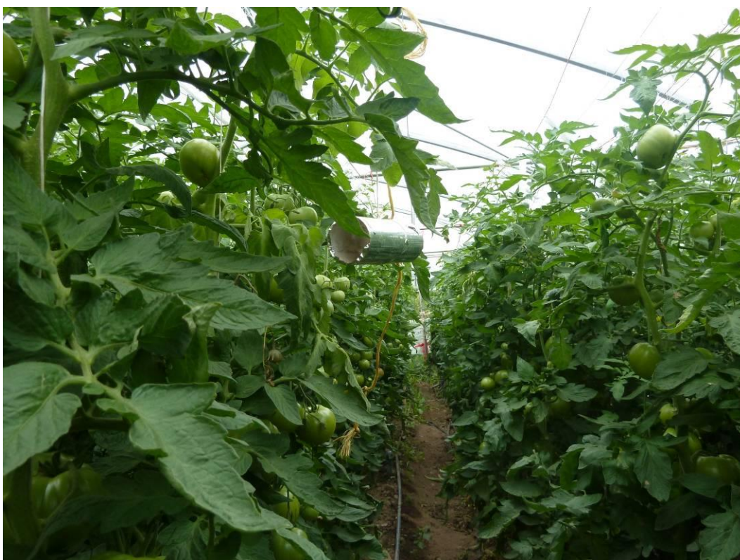
Photo 4 : Vue dans même direction le 5 septembre 2013. Le cylindre aluminisé agit comme bouclier pour la sonde HOBO. (Ferme B)
