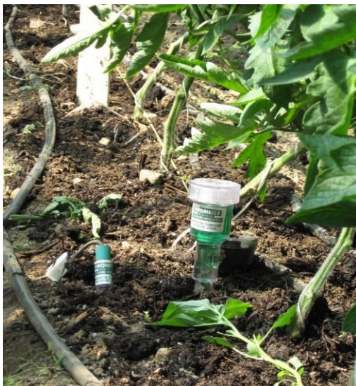
Photo 7 : Lysimètre (SSAT) et tensiomètre
