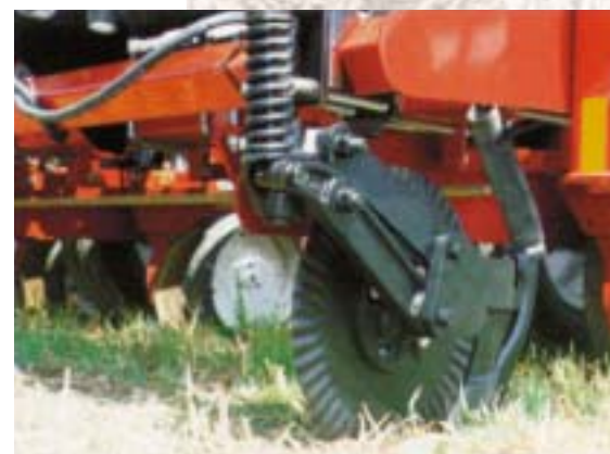
Disque monté sur un semoir permettant d'appliquer l'engrais sous la surface du sol
