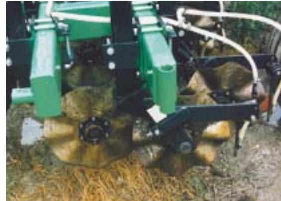
Incorporation d'engrais au sol à l'aide d'un équipement conçu pour le travail en bandes
