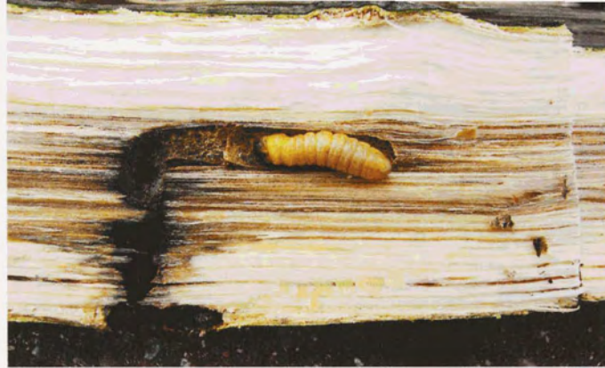
La galerie coudée est typique de ce longicorne. Lors de la première année, la galerie est creusée perpendiculairement aux fibres du bois et la deuxième année, elle est creusée dans le sens des fibres du bois. Photo: IQDHO
