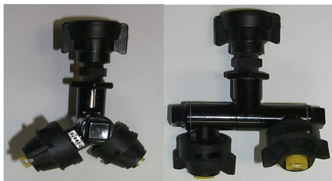
Photo 1. Arrangement de deux buses à jet simple À gauche : vue latérale; à droite : vue frontale Sur la photo : Composantes Teejet (Photo : Bertrand Grégoire, Gregson Technologies inc.)
