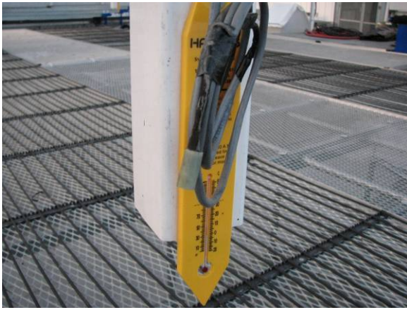
Photo 1 : Sonde qui a été retirée de sa cage. Sur ce modèle, l'extrémité sera retirée et remplacée.
