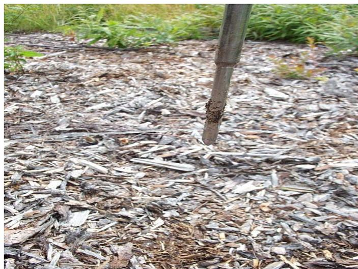
**Figure 6. Pointe de la tige d'injection (Gagnon S. et coll., 2005)**
