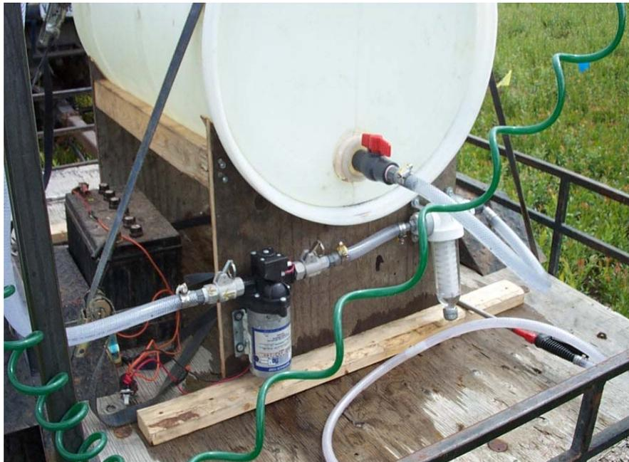
Figure 12. Système standard : pompe, boyau, réservoir et plate-forme (Agrinova, 2005)
