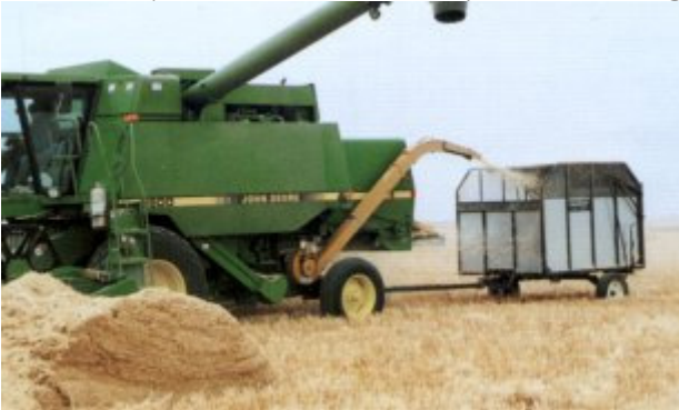
Photo 4 : Système de collecte des pertes de battage derrière la moissonneuse.
