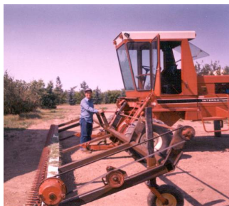
Photo 2 : Barre de coupe pour les mauvaises herbes fabriquée sur mesure et adaptée à une andaineuse.
