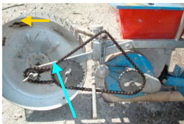
Mécanisme d'engrenage pour ajuster la densité de semis
