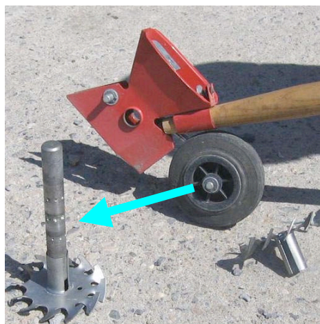
Vue de l'axe horizontal détaché du semoir avec les cavités (photo Reid Allaway)
