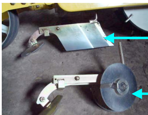
Ouvre-sillon : soc en V (en haut) ou disques (en bas)
