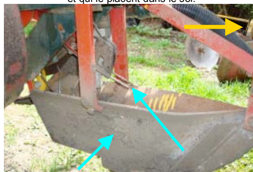
Figure 11 – Transplanteur à pinces Les flèches jaunes indiquent la direction d'avancement.
