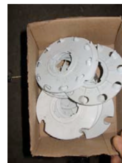
Disques pour semer des graines de différentes tailles
