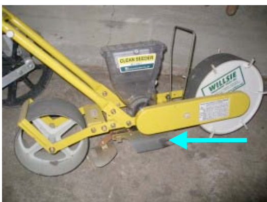
Semoir avec soc en V pour ouvrir le sillon
