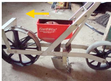
Roue avant assez grande qui ne requiert pas un lit de semence aussi parfait que pour le semoir Glaser.
