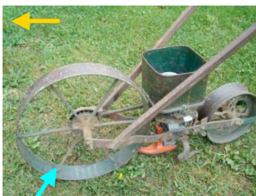
Roue avant à grand diamètre ne nécessitant pas un lit de semence très égal
