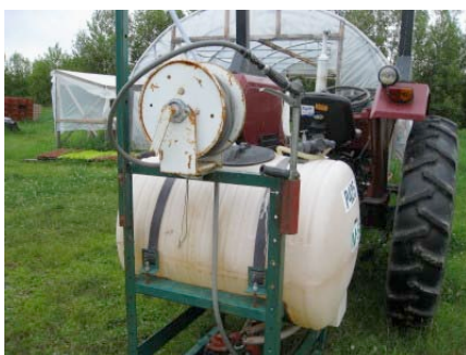
Figure 2 – Pulvérisateurs munis d'un tuyau pour faire une pulvérisation manuelle dans les zones non accessibles en tracteur (ex.: tomates tuteurées)
