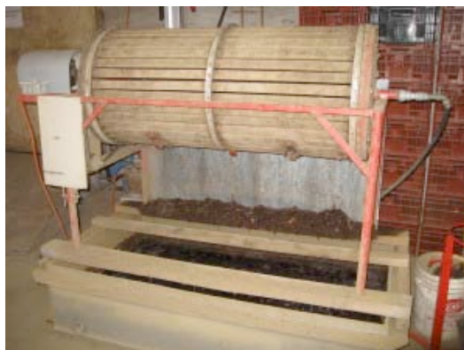
Figure 7 – Laveuse à carottes fabriquée à la ferme Vallon des sources par Michel Massuard
