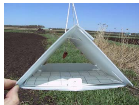
Piège Delta I : détail de l'intérieur du piège; notez que le rabat à l'avant du piège doit normalement être relevé comme celui du fond de manière à maintenir la plaquette engluée (carrelée en noir) bien en place. Source : MAPAQ, Saint-Rémi.
