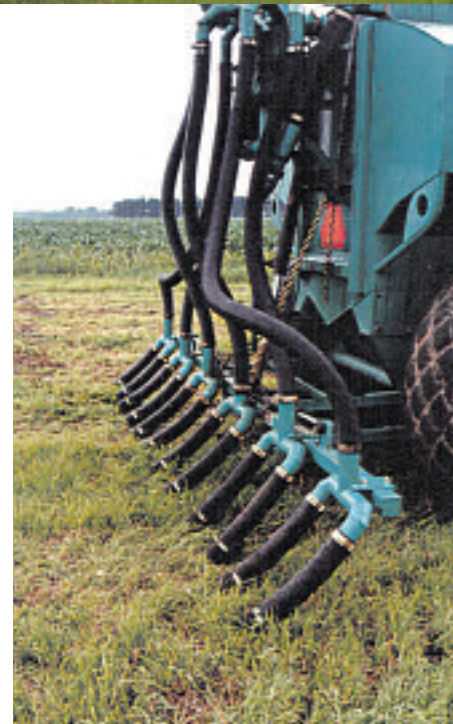
Rampe à prairies munie de pendillards
