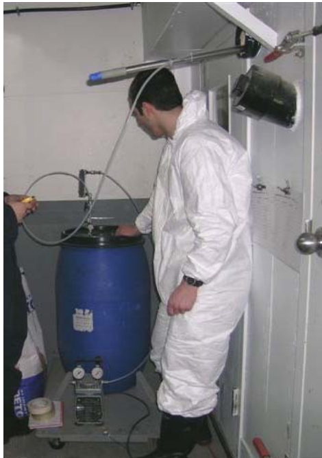
Figure 11 : Échantillonnage de l'air pour l'analyse d'odeur
