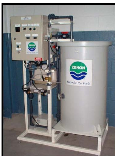
Figure 3.10 Bioréacteur à membranes immergées ZeeWeed ® ZW-10 (photo prise par ZENON Environmental Inc)
