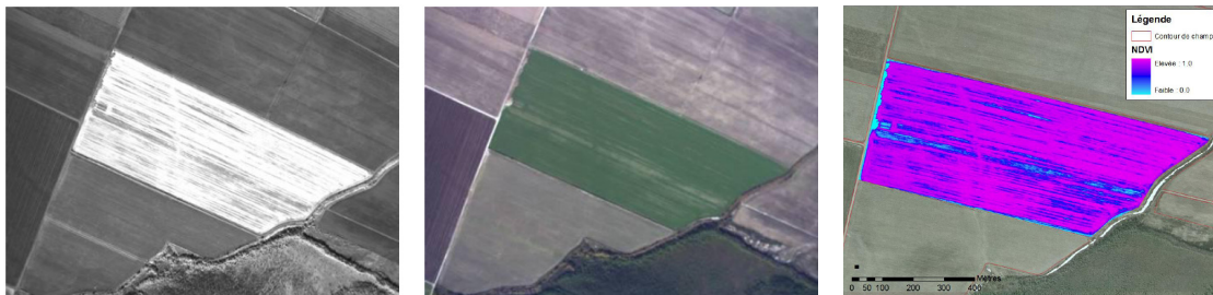
Figure 4. À gauche, image proche infrarouge; au centre, image couleur; à droite, résultat de l'indice de végétation.
