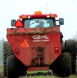
Fig.1 :Solide de gratte en « V » à l'épandage
