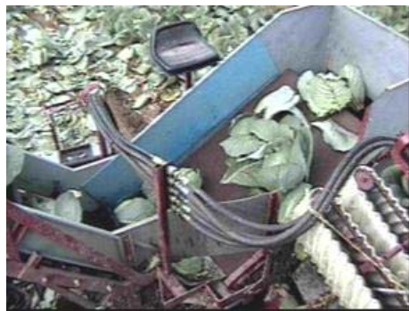
Figure 5 : Prototype de séparateur de feuilles
