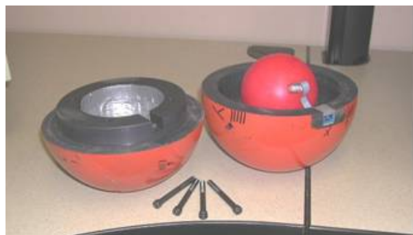
Figure 13 : Coque sphérique logeant l'appareil IRD
