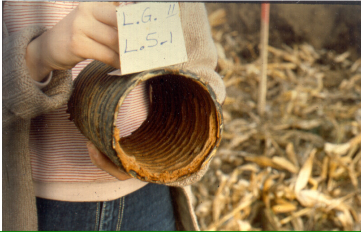
Cet important dépôt d'ocre de fer à la sortie indique un colmatage avancé du système de drainage.
