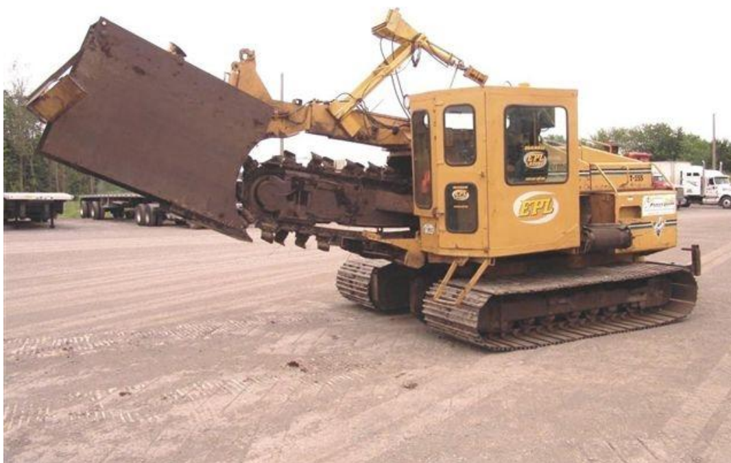
Photo 3 :Excavatrice a chaîne pour terre noire et argile sensible
