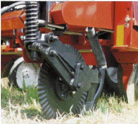
Disques à engrais installés sur un semoir à semis direct
