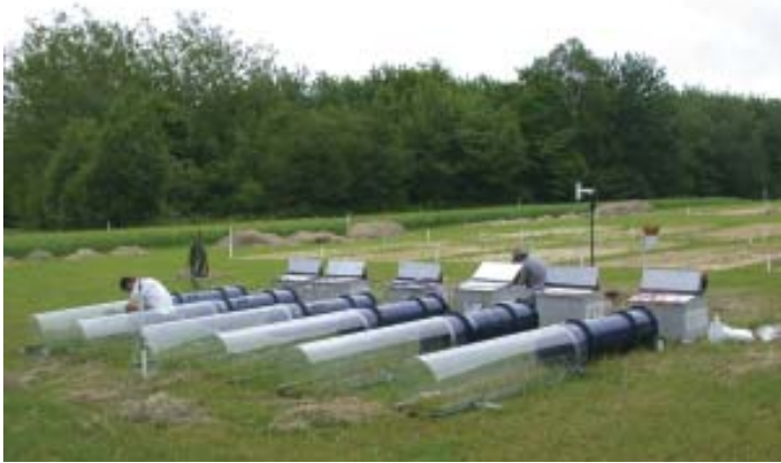
Tunnels ventilés utilisés à AAC (Ste-Foy) pour la mesure de la volatilisation de l'ammoniac suivant l'application de fumiers au sol.
