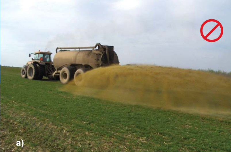
Figure 2 : À éviter. Formation de bruines lors de l'épandage de lisiers clairs par aéroaspersion basse. a) à la sortie de l'épandeur; b) à l'impact du lisier au sol.
