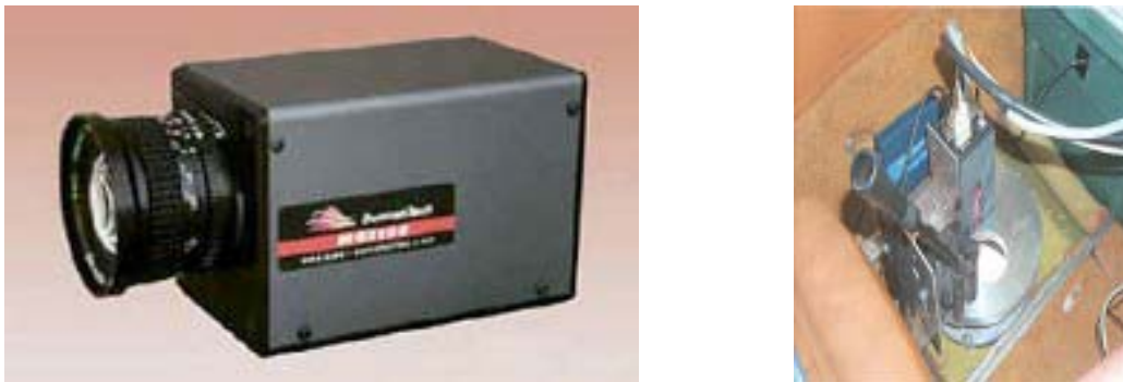
Figure 1- Caméra numérique à haute résolution utilisée et support de fixation dans l'avion
