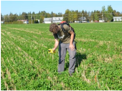
Figure 7 - Récolte de données avec le FieldScout CM1000
