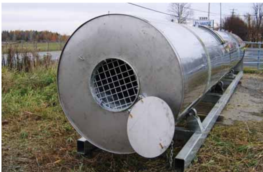
Compostage en bioréacteur (marque Biovator™)
