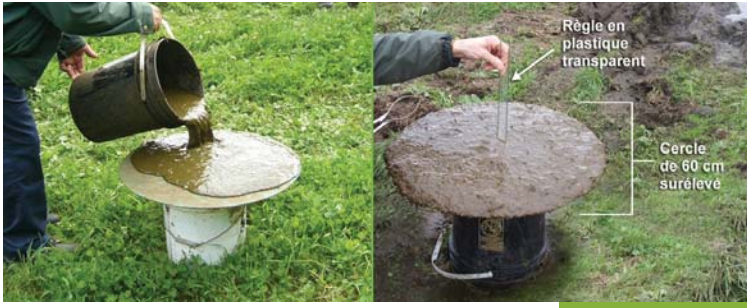
Prise de la mesure d'affaissement
