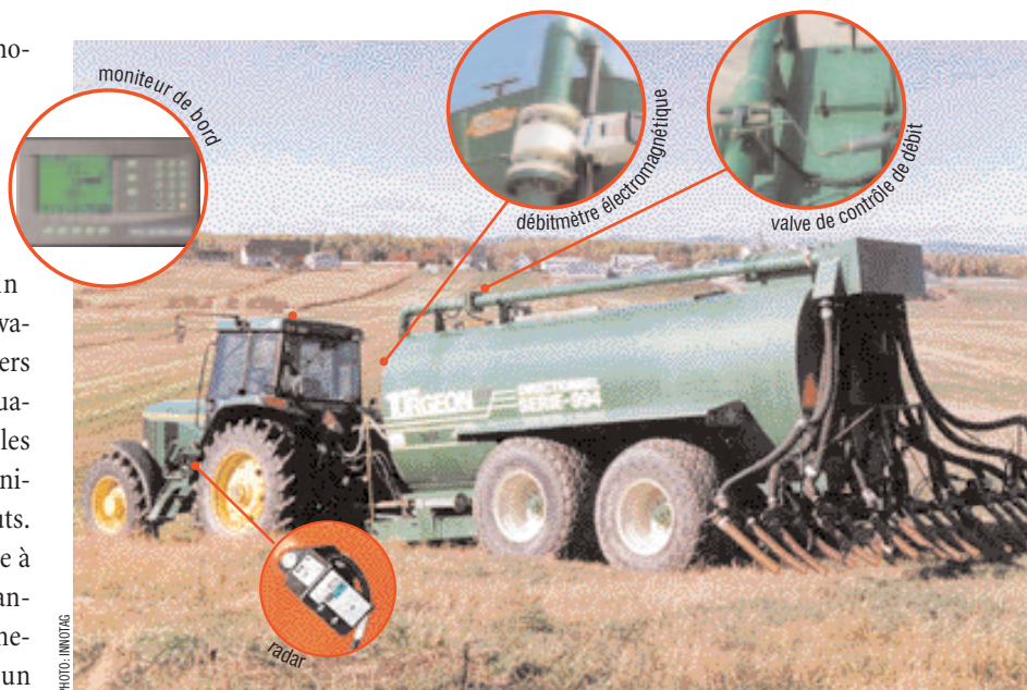
Installation typique d'un système informatisé de contrôle d'application sur un épandeur à lisier.
