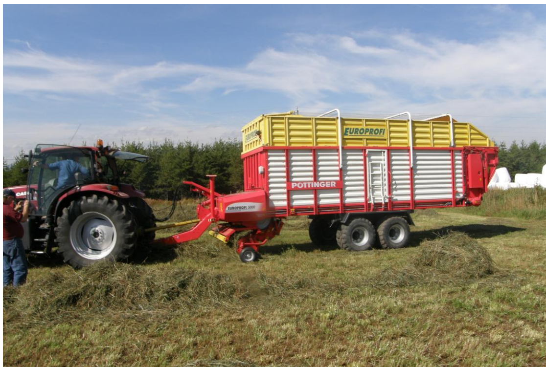
Autochargeuse Pöttinger de 50 m 3 utilisée à la Ferme Hengil http://www.youtube.com/watch?v=3AW9CO3ISXc&feature=youtu.be
