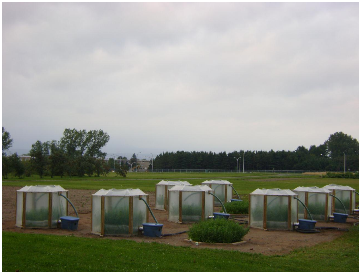
Figure 1. Site expérimental pour étudier les effets du CO 2 atmosphérique sur les mélanges luzerne-fléole des prés en Open-Top Chambers .
