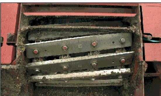
*Derrière les couteaux, les rouleaux rainurés assurent l'éclatement des grains et des tiges de maïs.*
