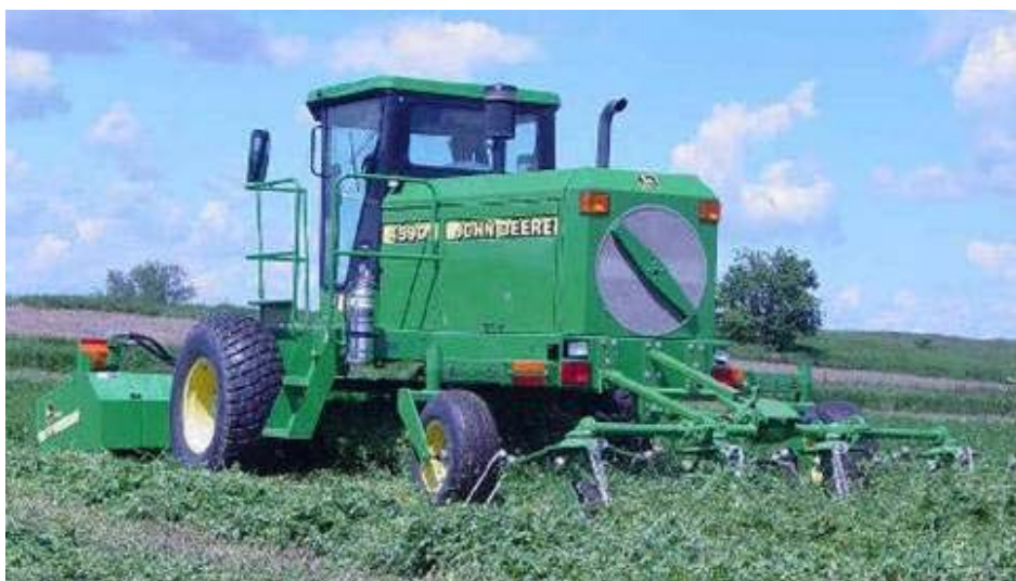
Faucheuse qui intègre une faneuse. Cette combinaison peut être utile pour les ensilages demi-secs (teneur en eau < 55%).
