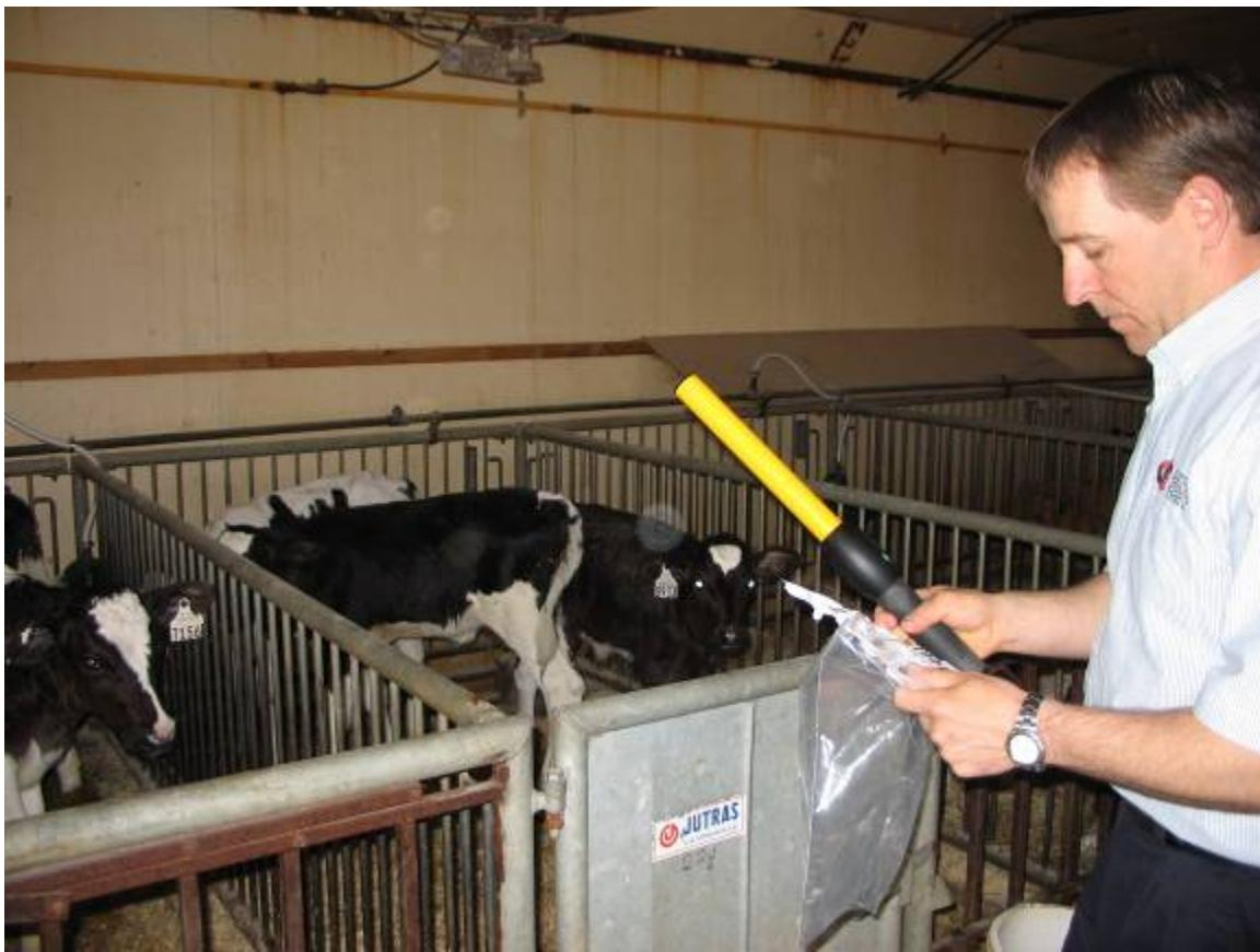
La Ferme Limar inc. s'est dotée quant à elle, d'un appareil de lecture de boucles de type *Stick Reader* afin de faciliter les déclarations d'entrées et de sorties des veaux. Cet appareil ne fait que lire et garder en mémoire les 15 chiffres de l'identifiant.
