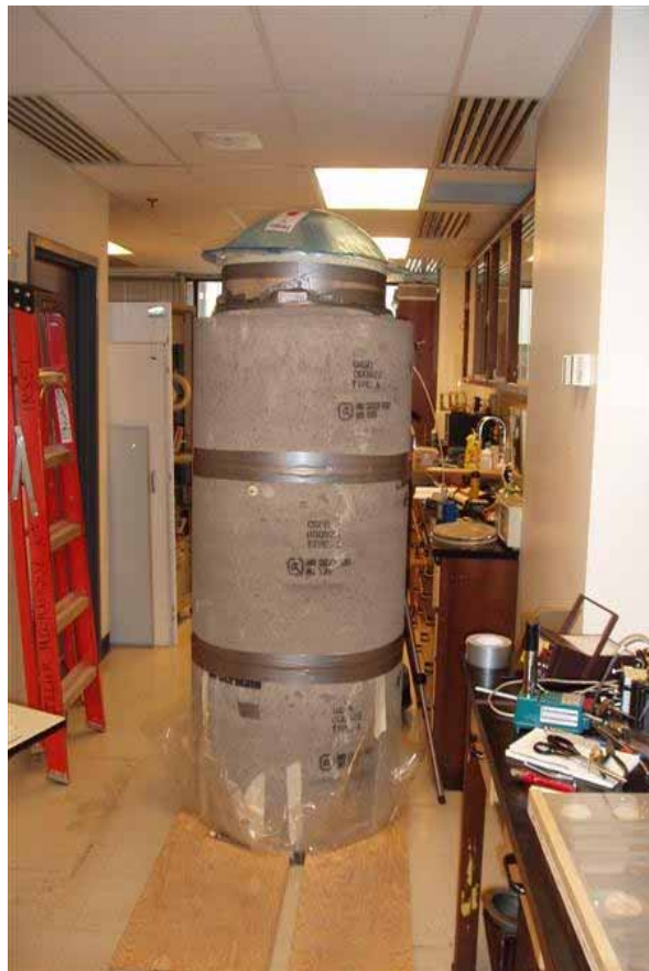
Figure 1 : Prototype de silo à échelle réduite
