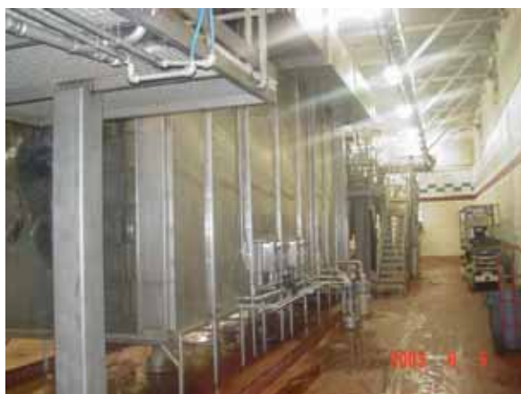
Cabine de lavage : aux USA les animaux morts sont fréquemment lavés avant d'être dépouillés
