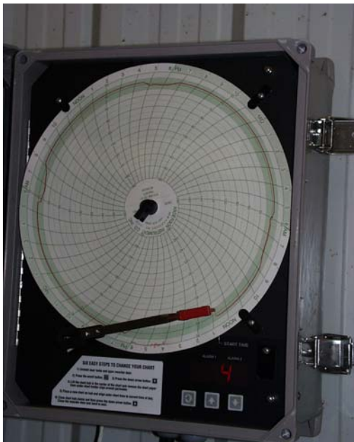
Figure 23. Le thermographe enregistre automatiquement la température du lait
