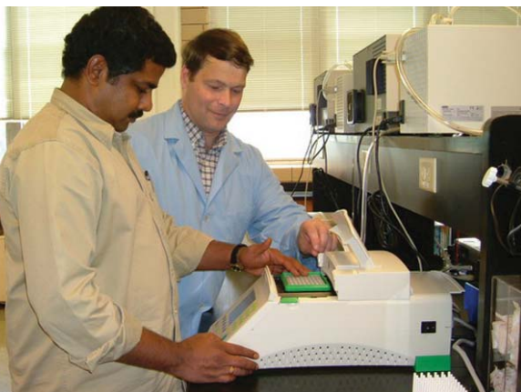
Trois éléments sont requis pour effectuer un test PCR : un tube PCR, différents réactifs et une source de chaleur.
