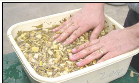
Figure 2 Agiter doucement la matière pour aider les grains à se déposer au fond de la bassine.
