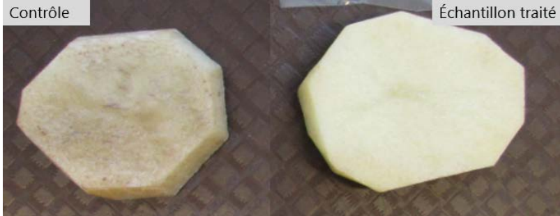
Pommes de terre après 7 jours, à la suite du traitement* à la lumière pulsée. (*Pendant 2 secondes au total pour les deux côtés. Entreposage avant le traitement à 7°C, après le traitement à 4°C)
