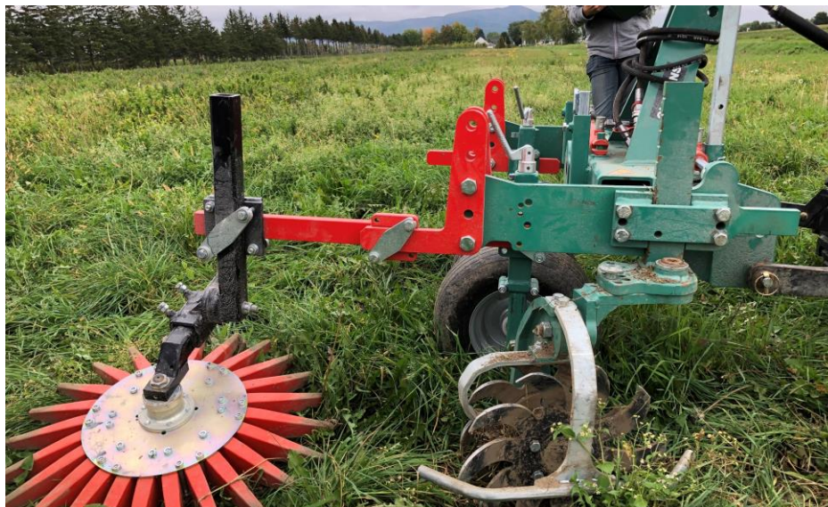
Étoile de binage Kress combinée aux disques émoteurs Clemens
