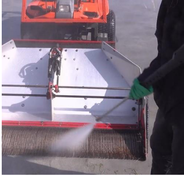
Nettoyage d'une récolteuse à bleuets pour prévenir la dissémination de la mouche du bleuets Source : Club Conseil Bleuets
