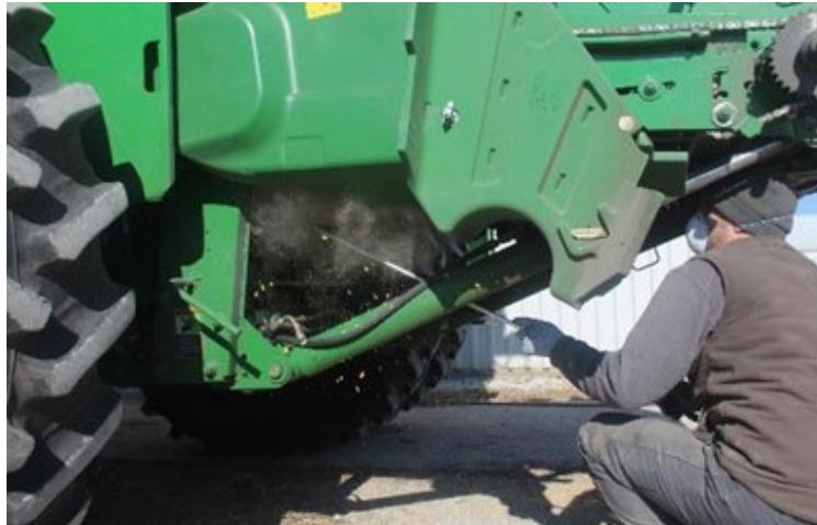
Photo 5 : Nettoyage final du piège à pierres avec un souffleur à feuilles ou un compresseur à air
