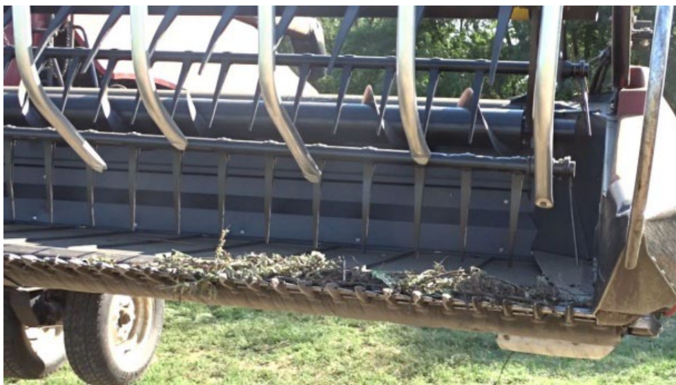
Photo 2 : Résidus coincés dans les sections de faucille de la plateforme de coupe
