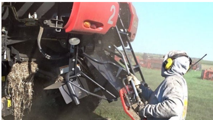
Photo 6 : Élimination des résidus laissés à l'extérieur de la moissonneuse-batteuse, y compris le secoueur de paille
