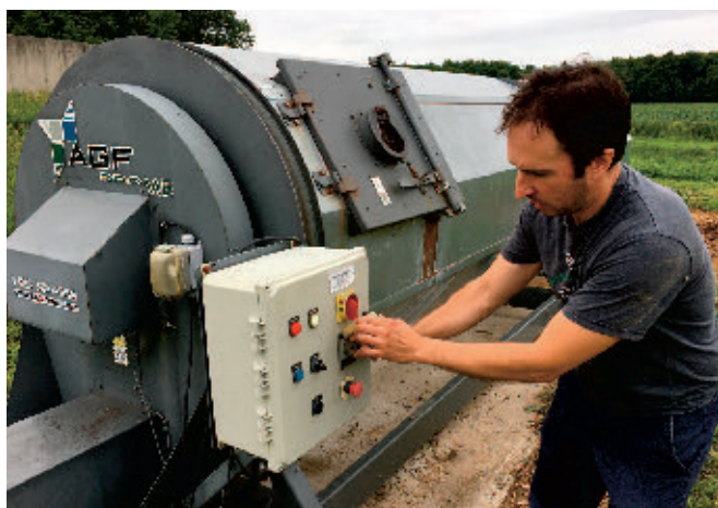
Le tableau de commande permet de configurer la minuterie et le nombre de tours du cylindre comme le démontre Julien Gauvin.
