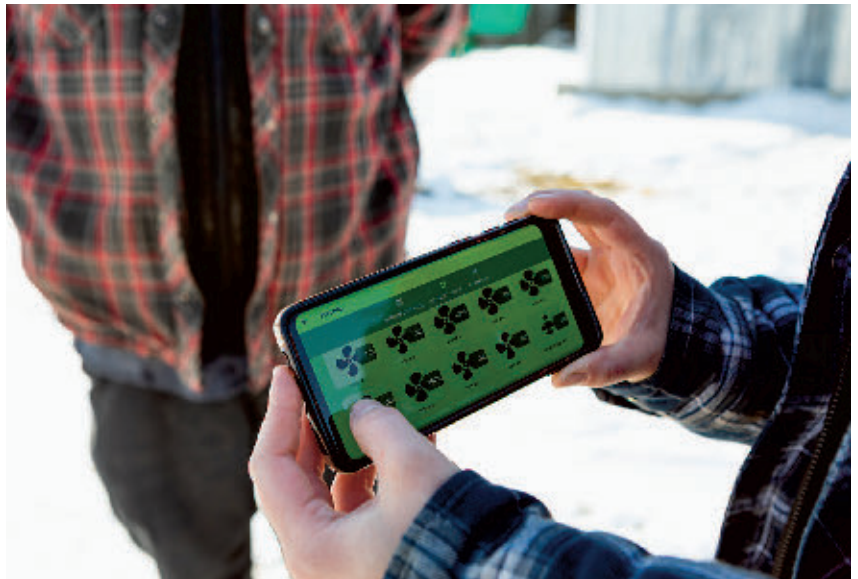
L'application du système Agrimesh sur les mobiles, comme les téléphones intelligents, permet de gérer les systèmes à distance et de voir ce qui se passe dans un bâtiment. Sur l'écran, on peut voir chacun des équipements qui est connecté au système central.
