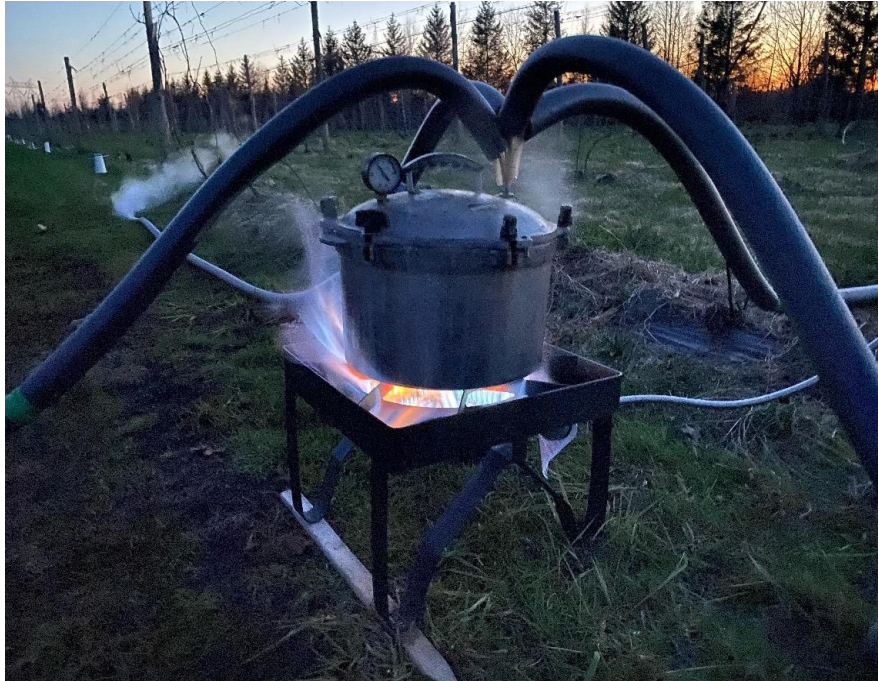
Figure 3. Photo du prototype conçu au Clos Lambert: une bouilloire de type Presto sur lequel ont été greffés 4 bras d'une longueur de 5m recouverts d'une membrane isolante. On distingue aussi une série de capteurs, à gauche en arrière-plan.
