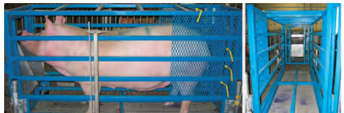
Photo 4. Balance à quatre plateaux pour mesurer la distribution du poids sur les pattes.
