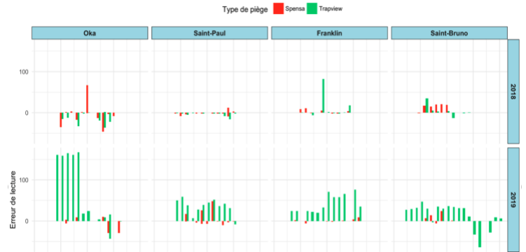
Fig. 1. Erreur de lecture de l'algorithme de détection et d'identification des pièges automatisés à l'essai (ex. de la tordeuse à bandes obliques, 2018-2019)
