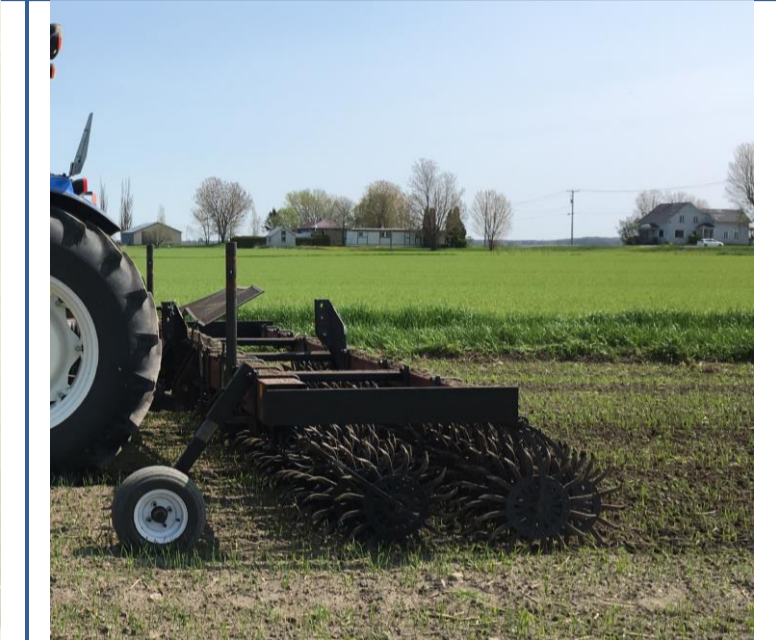
L'équipement qui a été utilisé est la houe double (photo à titre d'exemple). Les roues de profondeur ont été relevées de sorte que les cuillères de la houe puissent bien pénétrer le sol jusqu'à une profondeur d'environ 1,5 po. La vitesse d'avancement était de 20 km/h.
