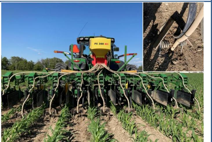
Il s'agit d'un sarclleur mi-lourd sur lequel un semoir à l'air est fixé. Les tuyaux de distribution des semences sont disposés sur les unités. Une plaque de métal en « V » a été ajoutée au-dessus de la pointe de la patte arrière (en « C ») du sarclleur afin de billonner le maïs. Les ressorts servent à faire vibrer le sol pour enterrer les semences.
