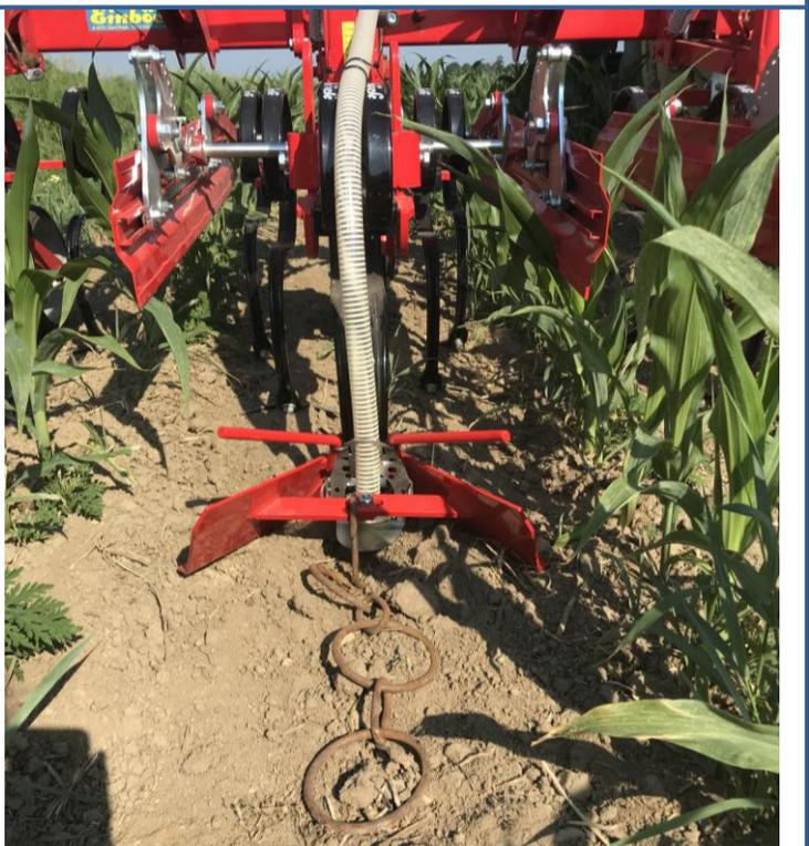
Le tuyau de distribution des semences est fixé à l'arrière des ailes billonneuses d'un sarclleur léger. L'ajout d'anneaux de métal sert à enfouir légèrement les semences.
