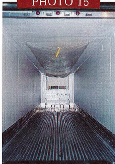
Un conduit de distribution d'air, un plancher à rainures profondes et un écran de reprise d'air favorisant la circulation d'air dans une semi-remorque frigorifique.
