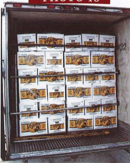
Des barres de blocage empêchant les produits de se déplacer vers l'arrière.
