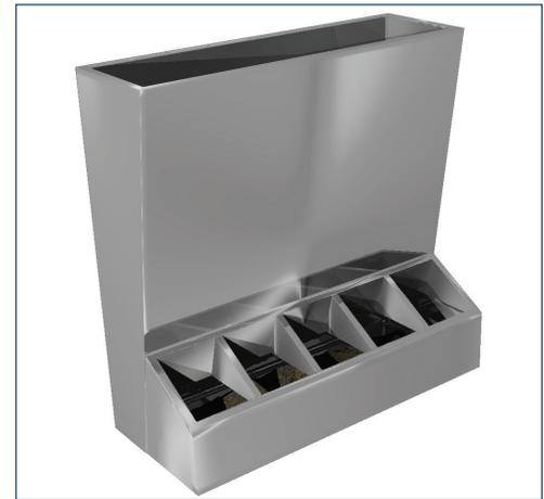
**Figure 4. Exemple de trémie fixe**
