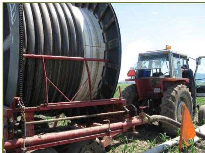
Figure 19. Enrouleur de type Cadman qui permet de rembobiner le tuyau flexible
