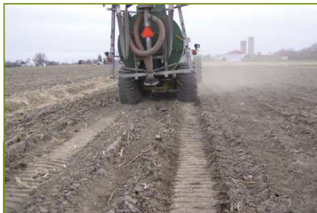
Figure 20. Simulation de compactage d'un sol avec une citerne à lisier au printemps
